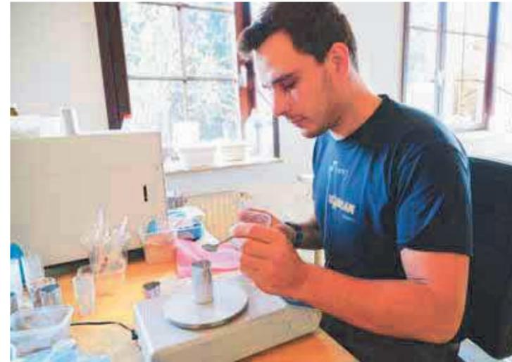
Philip Schierring wiegt genau definierte Mehlmengen ab, die in einem Hightech-Mini-Knetter mit einer vorgegebenen Wassermenge solange geknetet werden, bis die perfekte Konsistenz erreicht ist
