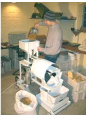
Mit einem Trieur kann kurzes Bruchkorn von Langkorn gleicher Dicke getrennt werden.
